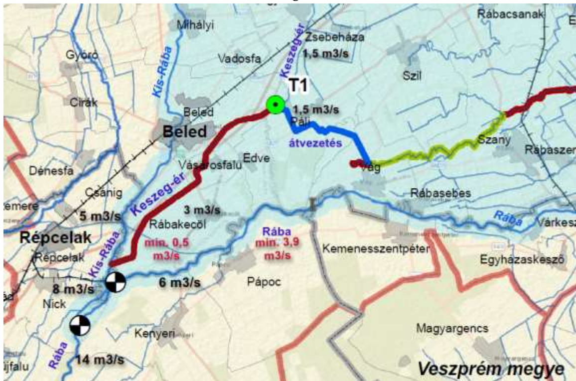
12. ábra: Vízszétosztási lehetőség a Rába ragyogóhídi szelvényének augusztus havi 80%-os meghaladási tartósságú értékénél
